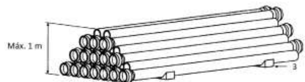
Armazenamento de tubos com embocadura em pilha
