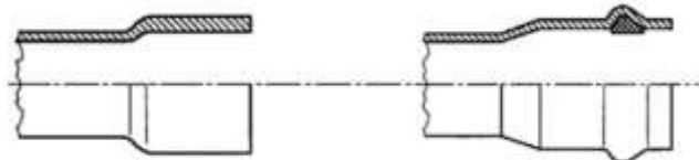
Pormenor da embocadura para colar
