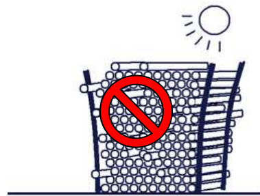
Maneira incorrecta de armazenar tubos no exterior por longos períodos
