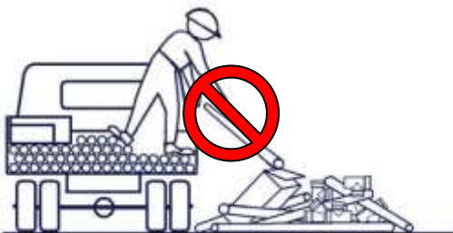
Maneira incorrecta de descarga de tubos e acessórios
