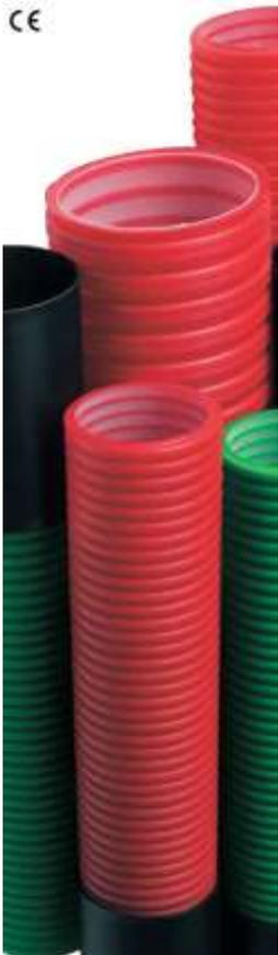
O tubo **2WW L250** fabricado em polietileno (PE), de dupla parede (interior liso e exterior corrugado). O seu perfil facilita a instalação dos cabos e proporciona uma boa resistência à compressão ( $\geq 250\text{N}$ ) e ao impacto (uso ligeiro (Serie L) com IK 07 a 9), destacando-se pela elevada flexibilidade.
